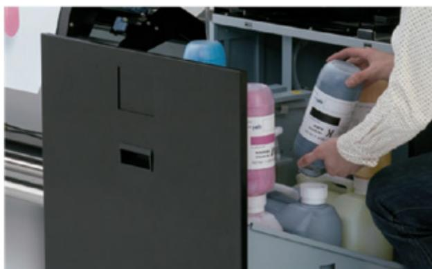
Projetado para maximizar sua produtividade de impressão, o modelo ColorPainter M-64s LCIS vem com um reservatório de tinta de grande capacidade de 4,5 litros para cada cor para suportar a impressão contínua de alto volume. Até 3 litros de tinta podem ser usados continuamente sem substituir os frascos de tinta.
