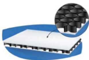
Parede espessa e construção das paredes verticais em círculos, o que se traduz numa estrutura bastante resistente. Trata-se de uma placa leve e de fácil corte, com elevada rigidez, resistente à humidade e aos principais agentes químicos e óleos. Pode ser usado em muitos ambientes diferentes como sinais, painéis de publicidade e itens promocionais.
