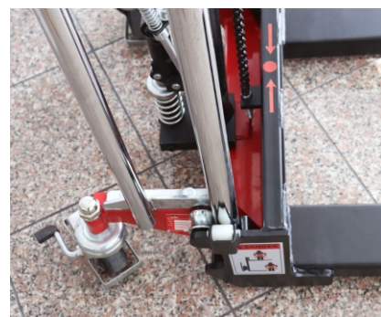
As rodas têm travão para facilitar o processo de carregamento dos rolos
