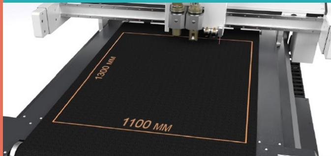
A mesa de vácuo em favo de mel de alumínio de resistência industrial com sistema de vácuo independente de 6 zonas garante um nivelamento perfeito para todos os tipos de meios. Feltro durável de 4 mm de espessura com excelente permeabilidade e boa resistência ao desgaste para uma longa vida útil. A mesa é fornecida com uma bomba de vácuo potente para uma pressão descendente superior, garantindo que não há movimento durante as operações.
