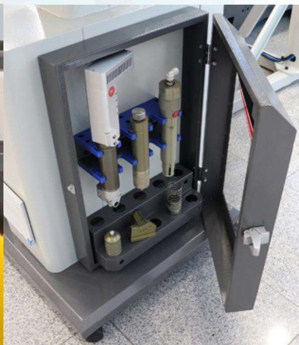
Armazém de ferramentas para fácil organização de ferramentas e cabeças de corte em uso, de modo a substituir as ferramentas rapidamente e convenientemente.
