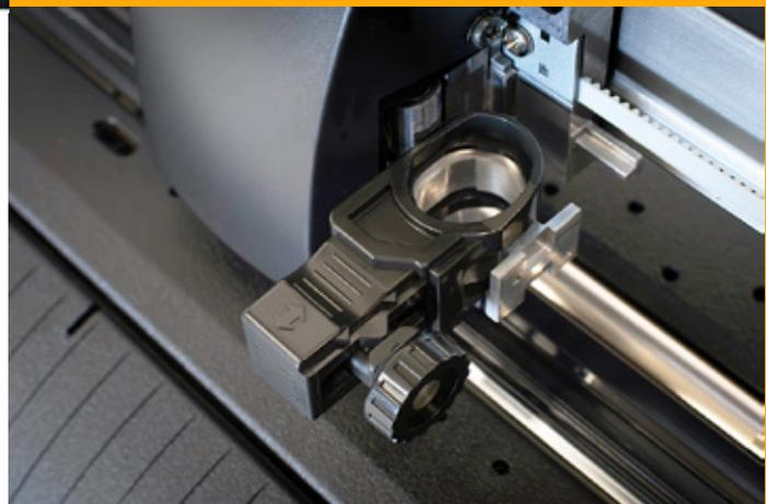
O compartimento das ferramentas tem agora uma base magnética que facilita a sua deslocação e permite a sua remoção, se necessário.
