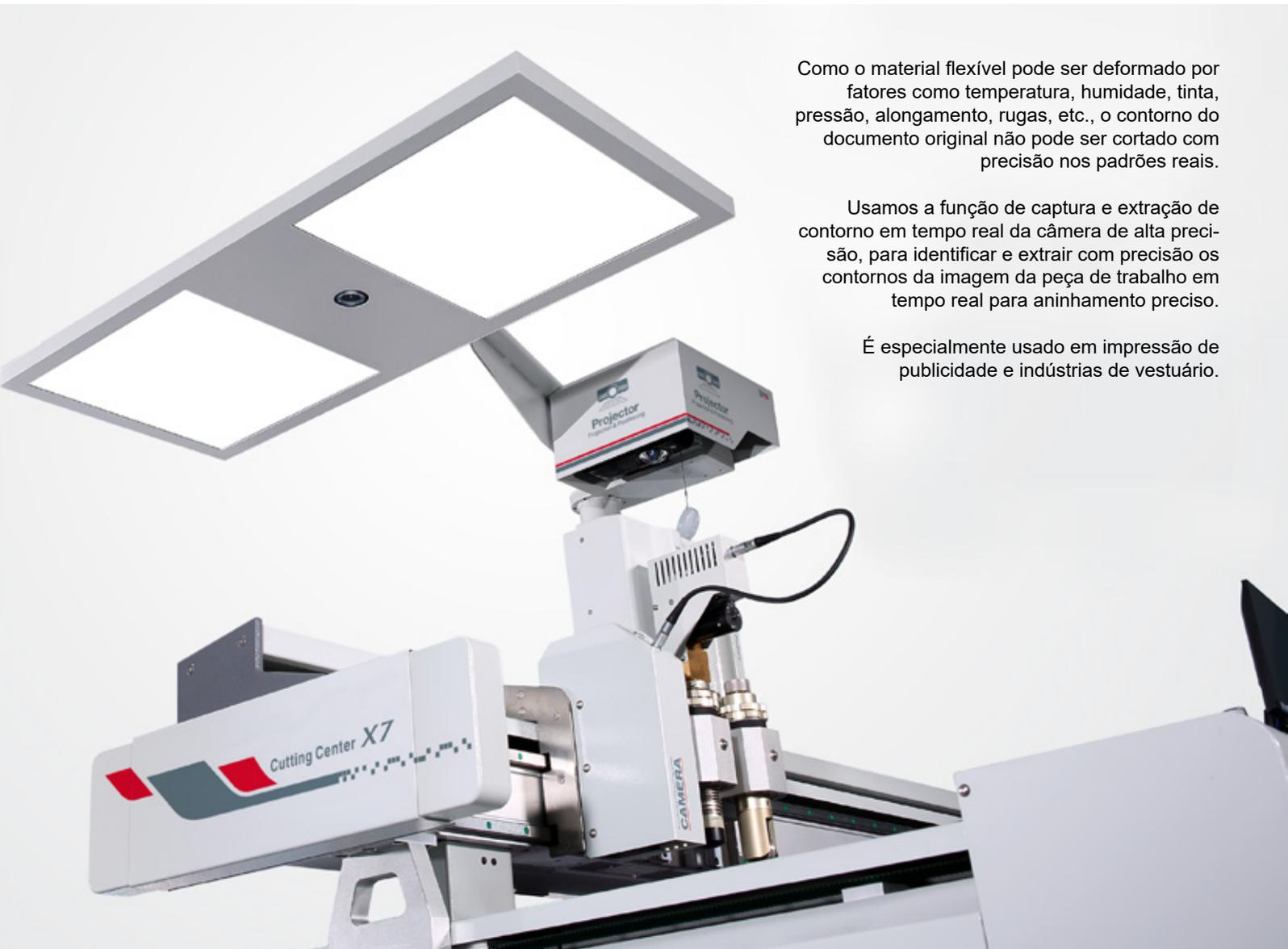
Como o material flexível pode ser deformado por fatores como temperatura, humidade, tinta, pressão, alongamento, rugas, etc., o contorno do documento original não pode ser cortado com precisão nos padrões reais.
